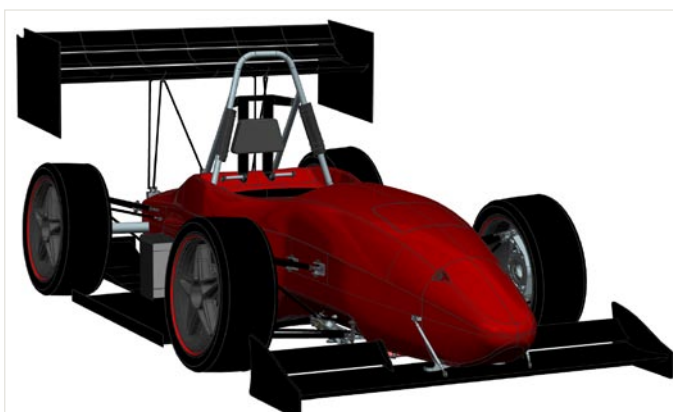
3D-Modell des theta2013 mit Front- und Heckflügeln Bildrechte: DART Racing Team e.V.
