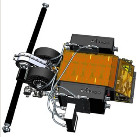
3D-Modell des neuen Antriebskonzepts, mit Elektromotoren, Getriebe, Motor-Controllern und Batterie Bildrechte: DART Racing Team e.V.
