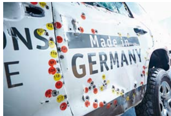
Beschussprüfung eines von Farmingtons Automotive ausgerüsteten Toyotas, erforderlich für die Zertifizierung durch staatliche Beschussämter Bildrechte: Farmingtons Automotive
